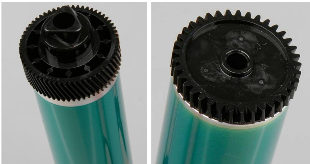
4. На ведущей шестерне 60 зубьев, заземляющий контакт барабана находится со стороны шестерни с меньшим количеством зубьев. Шестеренки черного цвета.
